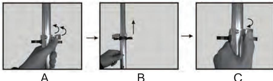
Покрутите контргайку на хомуте рулевой стойки, чтобы ослабить эксцентрик. Отведите в сторону эксцентрик на рулевой стойке, как показано на рисунке. Нажмите на пружинную кнопку и одновременно потяните рулевую стойку вверх, до необходимой высоты, пока пружинная кнопка полностью не выйдет из соответствующего отверстия на рулевой стойке. Прижмите эксцентрик и зафиксируйте его, затянув контргайку. Чтобы сложить самокат, произведите те же действия в обратной последовательности.
